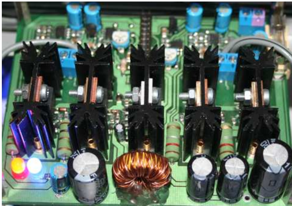
Rysunek 5.12 Widok skonstruowanego podwójnego mostka H
