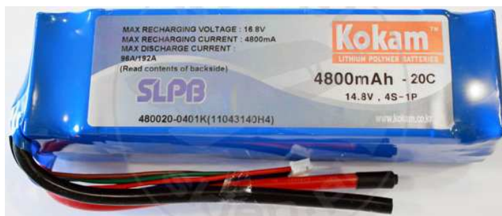
Rysunek 5.16 Akumulator Li-Poly 4800mAh 14,8V
