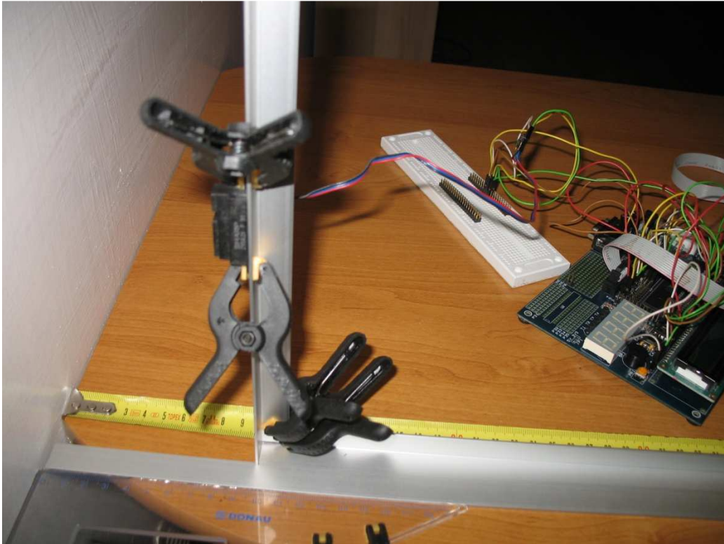
Zdjęcie 5 Testy czujnika SHARP 2Y0A21
