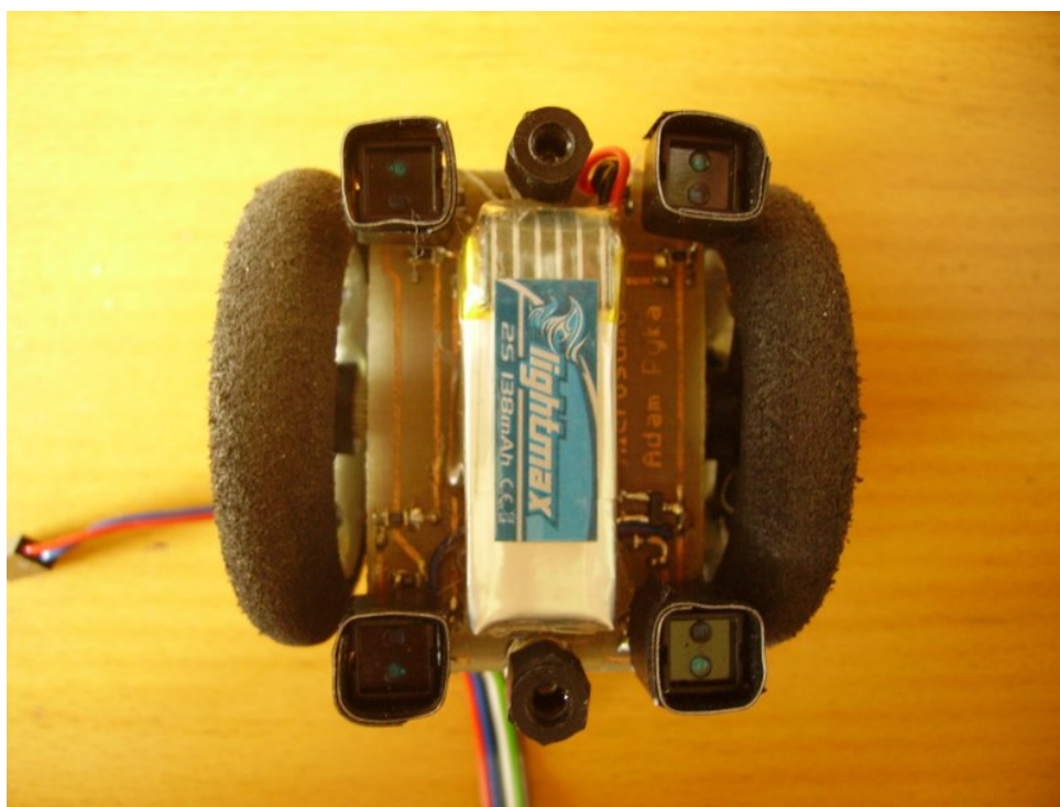
Rysunek 5.4 Moduł czujników linii – fotografia zamontowanego w robocie modułu
