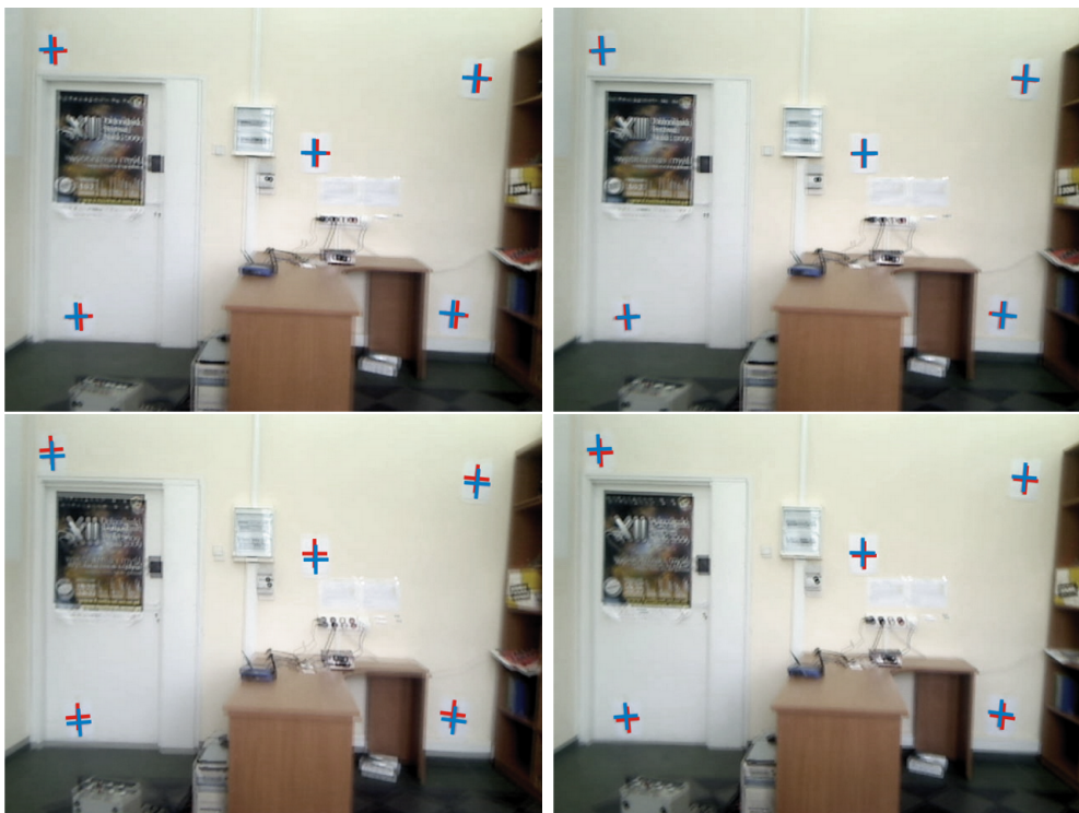
Rysunek 5.16 Kamera wyposażona w kodery położenia. Przeciwny kierunek pozycjonowania przygotowawczego i powrotnego. Pozycjonowanie kolejno od: lewej, prawej, góry, dołu.
