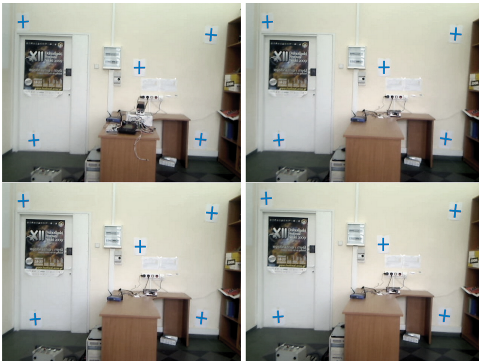
Rysunek 5.15 Kamera wyposażona w kodery położenia. Zgodny kierunek pozycjonowania przygotowawczego i powrotnego. Pozycjonowanie kolejno od: lewej, prawej, góry, dołu.
