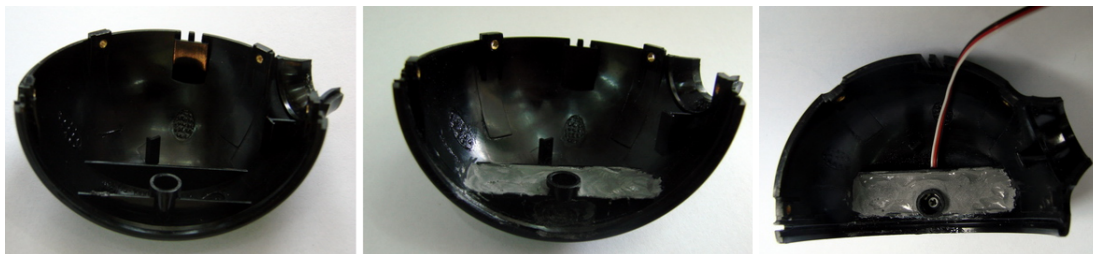
Rysunek 3.3 Półkula obudowy kamery. Kolejno od lewej: oryginalna obudowa; obszar wypełniony klejem oraz przygotowany otwór montażowy; osadzony i zabezpieczony potencjometr wraz z przewodami.
