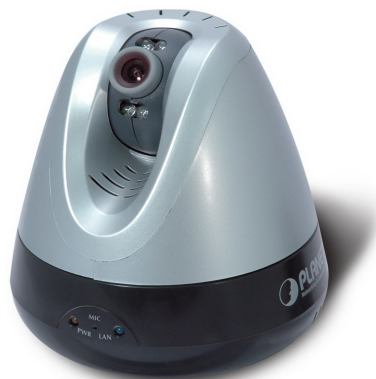
Rysunek 2.5 Kamera sieciowa Planet ICA-HM230.
