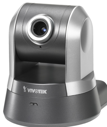
Rysunek 2.6 Kamera sieciowa Vivotek PZ7151.
