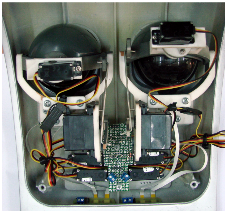
Rysunek 3.9 Wnętrze głowy robota - rozmieszczenie elementów mechanicznych i elektronicznych.
