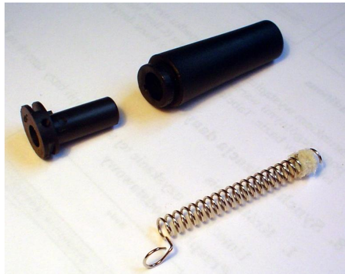
Fot. 2. Oryginalna antena helikalna
