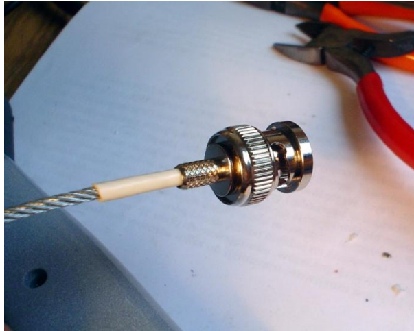
Fot. 15. Linka osadzona we wtyku
