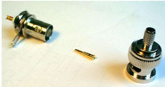
Fot. 3. Gniazdo i wtyk BNC
