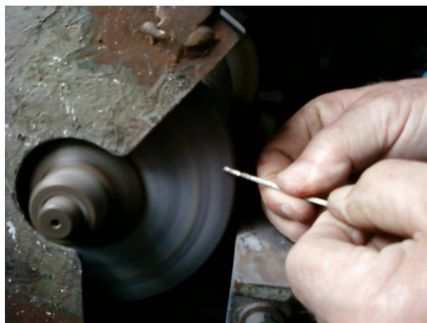
Fot. 11. Nadanie końcówce linki kształtu stożka ułatwi jej połączenie z pinem
