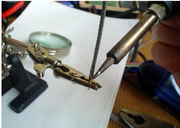
Fot. 12. Przylutowanie linki do pinu
