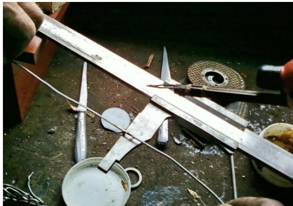
Fot. 10. Cyna zabezpieczy linkę przed rozplataniem się w miejscu przycięcia
