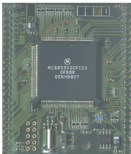
Rysunek 3.14 Moduł z mikrokontrolerem MC68332 [2]
