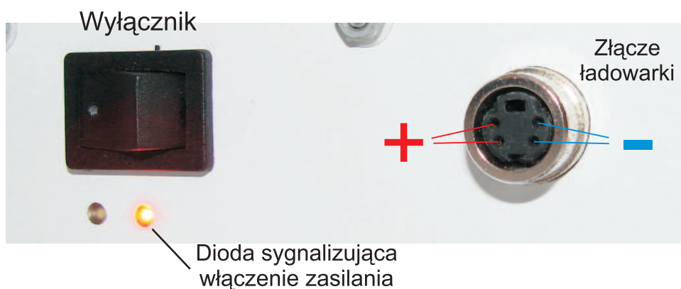
Rysunek 3.22 Tylny panel robota BlueScreen V2
