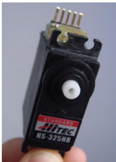
Fot. 5 – Widok przerobionego serwomechanizmu.
