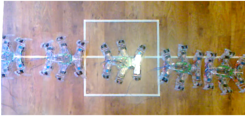
Rysunek 5.35 Przemieszczenie robota wzdłuż prostej ( V_y = 40\text{mm/s} , wysokość korpusu 90mm)
