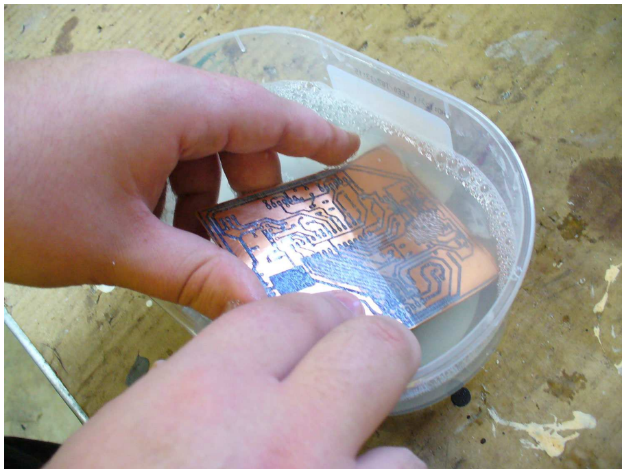
Oczyszczanie płytki z pozostałości po papierze kredowym.
