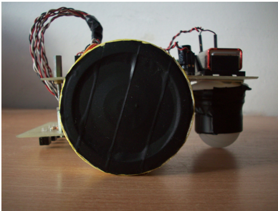
Rys. 10 Robot widziany bokiem z widoczną wysuniętą do przodu płytką z czujnikami
