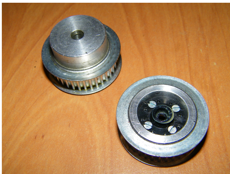
Zdjęcie 13: Oryginalna zębatka, oraz przerobiona z zamocowanym orczykiem
