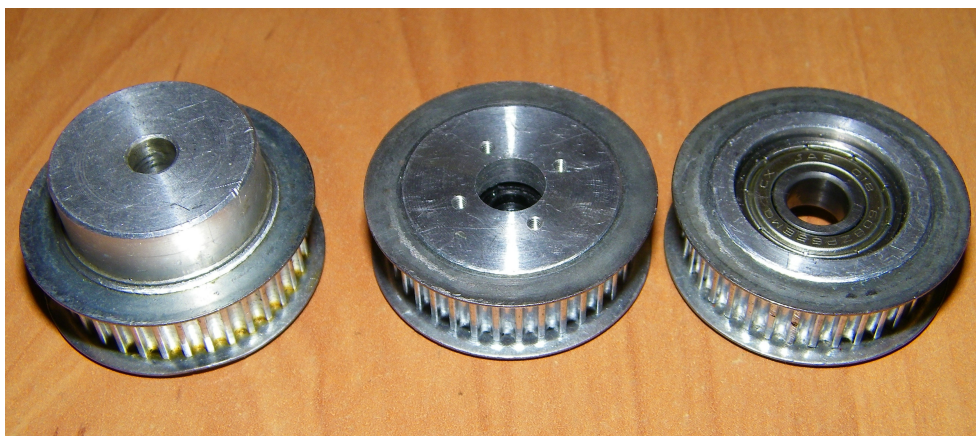
Zdjęcie 7: Koła zębate, od lewej: oryginalne, przystosowane do orczyka, łożyskowane
