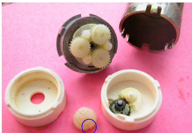
Rysunek 4: Uszkodzona przekładnia silnika
