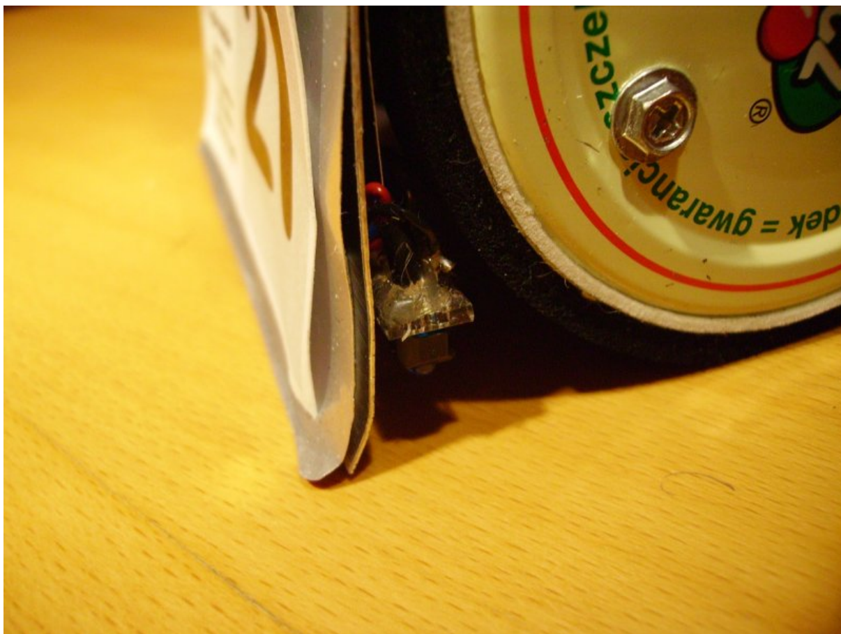
Rysunek 3: Warstwowy pług robota Łowicz - widoczny także czujnik białej linii.
