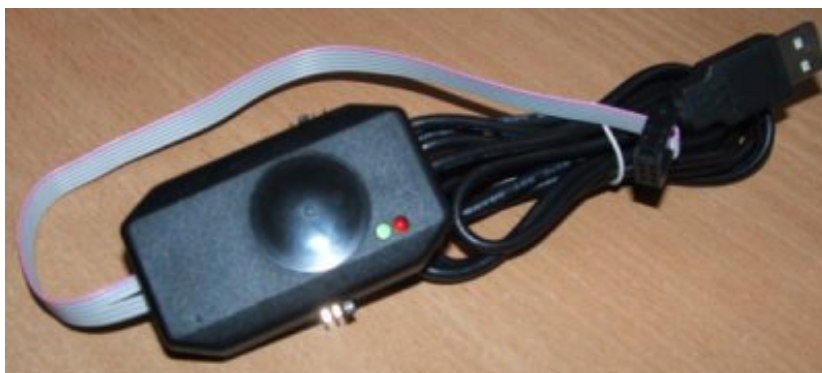
Rysunek 1: Interfejs TBDML i OSBDM
