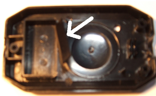
Rysunek 7: Fragment, który należy wylamać z obudowy
