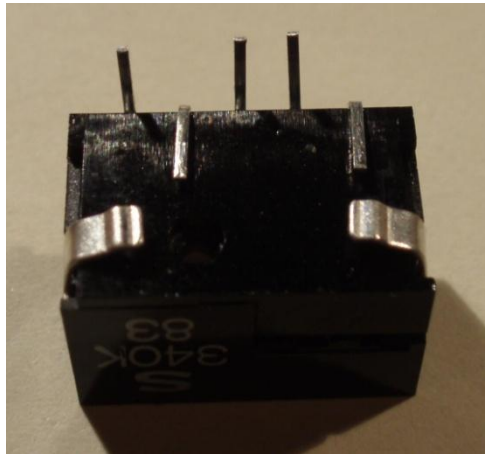
Fot.2 Wygięte nóżki czujnika
