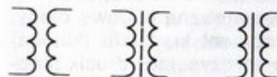
Symbole graficzne transformatorów (od lewej): wielkiej częstotliwości (bez rdzenia i z rdzeniem ferrytowym) oraz małej częstotliwości (z rdzeniem z blachy stalowej)
