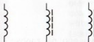
Symbol graficzny cewki (od lewej): bez rdzenia, z rdzeniem ferrytowym i z rdzeniem z blachy transformatorowej
