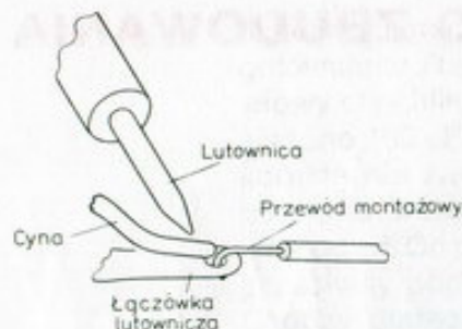
Prawidłowe operowanie lutownicą
