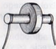
Dławik wielkiej częstotliwości może być nawinięty na rezystorze
