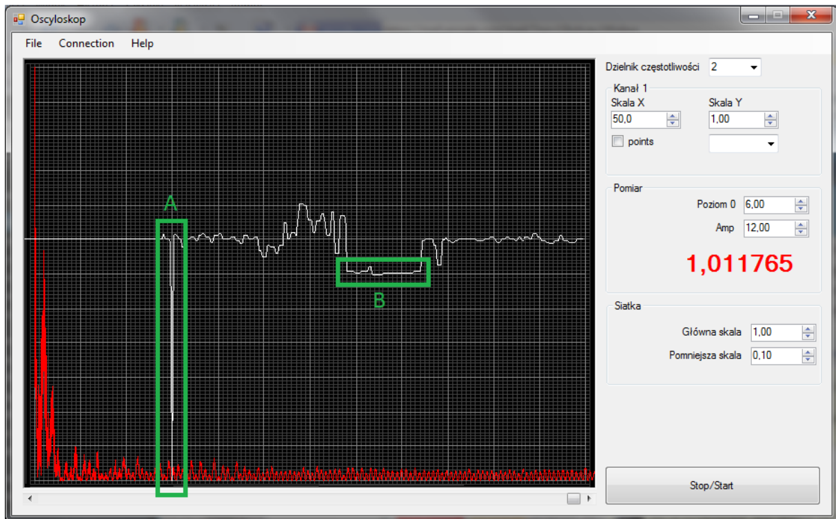
Rysunek 12: Rezultat badania spadku swobodnego w trybie 5. Obszar A - szpilka spowodowana naciśnięciem przycisku. Obszar B - Moment spadku swobodnego
