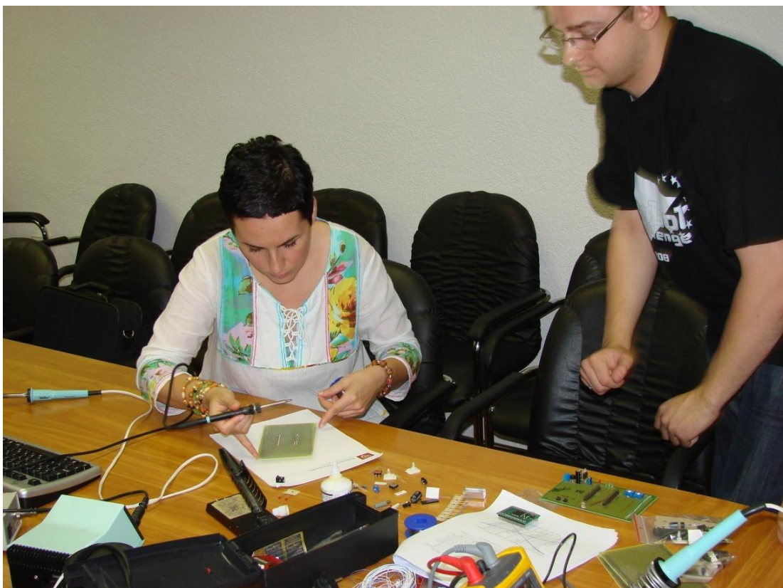
Fot. 7. Drugi dzień warsztatów – montaż płytek rozwojowych dla modułów z mikrokontrolerem HC12.
